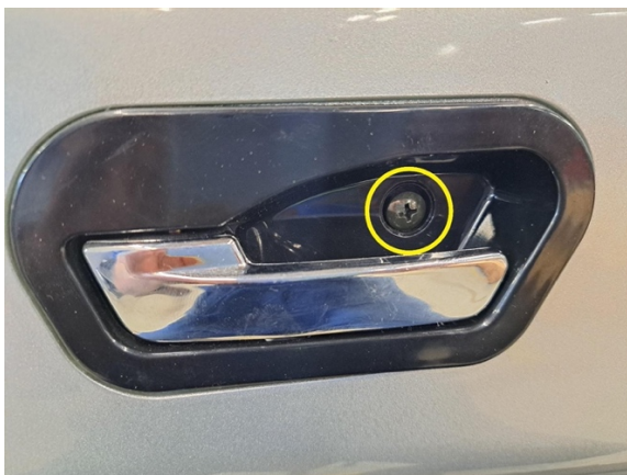
Irrota ovenkahvan kiinnitysruuvit. (ristipäämeisseli ph2).
